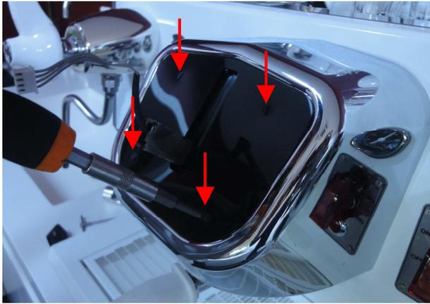
Svitare le viti di fissaggio del plexiglas e rimuoverlo.
