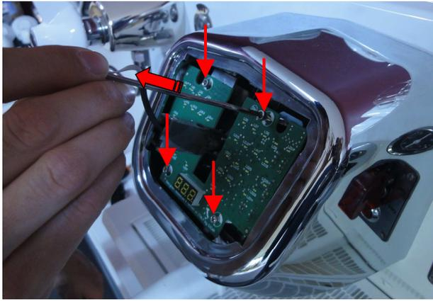
Svitare le viti di fissaggio scheda elettronica e scollegare i cavi indicati.
