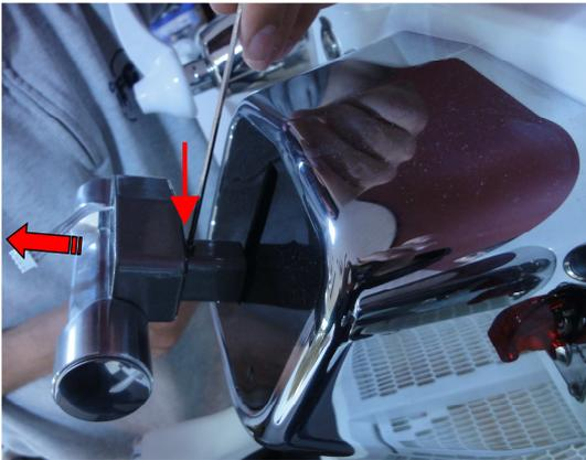
Svitare le viti di fissaggio della leva e rimuoverla.
