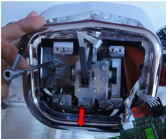
Svitare le viti di fissaggio del meccanismo e rimuoverlo.
