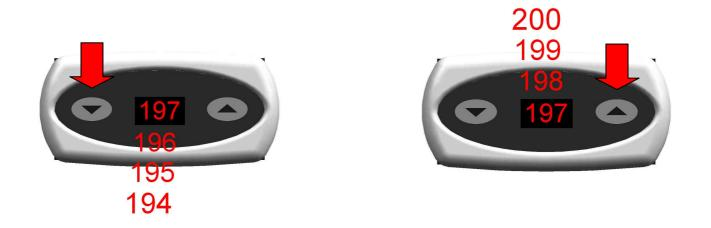
THE TEMPERATURE THAT YOU WISH TO PROGRAM CANNOT BE LESS THAN <u>176°F OR MORE THAN 266°F.</u> <u>AFTER 3 SECONDS, FROM YOUR FINAL INPUT, THE PROGRAM IS IN MEMORY</u> <u>AND THE ACTUAL TEMPERATURE WILL APPEAR ON THE DISPLAY.</u>
