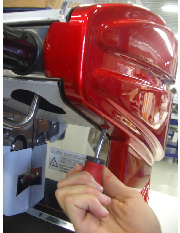
Svitare e togliere le 2 viti superiori e la vite inferiore di fissaggio del pannello laterale.
