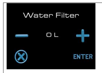
Funzione filtro acqua; questo parametro permette di impostare agendo sui tasti + e - la quantità d'acqua in litri dopo la quale sarà necessario rigenerare l' addolcitore. Raggiunta la quantità d'acqua impostata il display visualizzerà un messaggio che indica la necessità di rigenerare il filtro (vedi immagine seguente). Premendo il tasto enter si passa alla funzione successiva.
