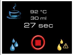
Per resettare il parametro accedere al menù lettura contatori totali, premere per un tempo superiore a tre secondi l'icona indicata e l'allarme verrà resettato.
