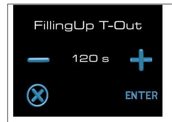
Funzione time-out caricamento; questo parametro regola il tempo massimo di caricamento acqua in caldaia. Se nel tempo prestabilito non viene raggiunto il livello di acqua necessario viene visualizzato un messaggio sul display (vedi immagine sotto). Impostare il tempo desiderato in secondi agendo sui tasti + e -. Premendo il tasto enter si passa alla funzione successiva.
