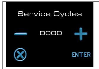
Funzione cicli manutenzione; questo parametro permette di impostare il numero di cicli dopo il quale sarà necessario un intervento di ordinaria manutenzione. Viene impostato a step di 1000 cicli. Impostare il numero di cicli desiderato agendo sui tasti + e -. Raggiunto il numero di cicli impostato il display visualizzerà un messaggio che indica la necessità di effettuare la manutenzione (vedi immagine seguente). Premendo il tasto enter si passa alla funzione successiva.
