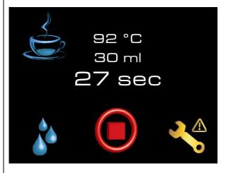
Per resettare il parametro accedere al menù lettura contatori totali, premere l'icona indicata per un tempo superiore a tre secondi e l'allarme verrà resettato.
