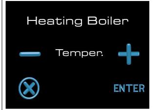
In selezione Temperature si accede al menù impostazione temperatura con relativi parametri PID (boiler kP,boiler kl, boiler kD, Pid boiler set.) che ne regolano il riscaldamento. É sconsigliato modificare i parametri contenuti in questa sezione, perché regolati in fabbrica da operatori qualificati.
