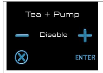
Funzione tè con pompa; questo parametro controlla la miscelazione dell'acqua per il tè. Se abilitata, durante l'erogazione d'acqua viene azionata la pompa per garantire una miscelazione più precisa e costante, ovviando ad eventuali sbalzi di pressione della rete idrica in ingresso. Se disabilitata la miscelazione avviene senza l'ausilio della pompa. Può essere abilitata o disabilitata agendo sui pulsanti + e -. Premendo il tasto enter si passa alla funzione successiva.
