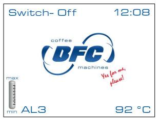
In questo caso è necessario verificare sia presente la connessione acqua in ingresso e controllare sul manometro che ci sia pressione. Se il collegamento alla rete idrica è corretto basterà resettare la segnalazione spegnendo e riaccendendo la macchina; la macchina riprenderà il caricamento fino al raggiungimento del livello.
