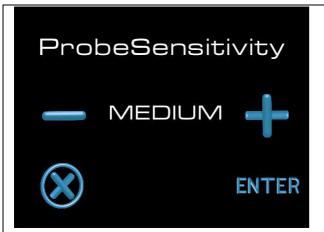
Funzione sensibilità sonda; questo parametro regola la sensibilità della sonda livello acqua in caldaia. Il valore può essere impostato agendo sui pulsanti + e - su tre differenti livelli di sensibilità; alta (indicata in presenza di acqua povera di sali minerali), media (indicata in presenza di acqua addolcita con tradizionale addolcitore) o bassa (indicata in presenza di acqua ricca di sali minerali). Premendo il tasto enter si passa alla funzione successiva.
