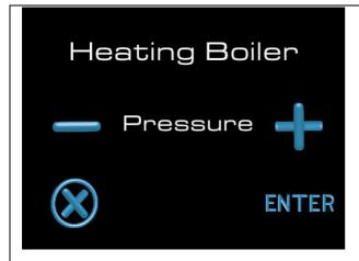
Funzione riscaldamento caldaia; questo parametro permette di gestire il riscaldamento caldaia tramite pressostato (Pressure) o tramite sonda di temperatura (Temperature).
