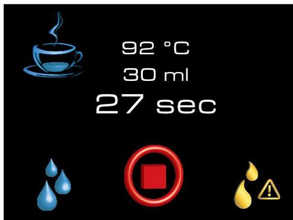
Se in fase di erogazione viene visualizzato il simbolo indicato significa che è necessario cambiare il filtro acqua. Tale operazione deve essere effettuata da personale tecnico qualificato.
