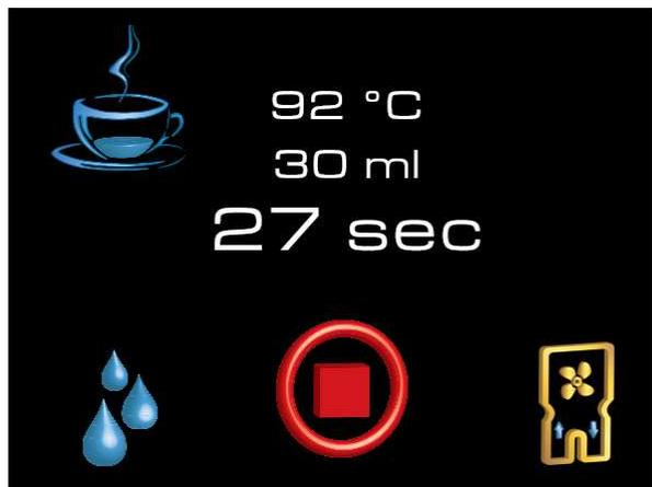
Se in fase di erogazione viene visualizzato il simbolo indicato significa che non pervengono gli impulsi dal contatore volumetrico rispetto al gruppo attivato perché interrotto o bloccato. Eseguire una dose completa a vuoto e verificare se la dose viene eseguita correttamente; in questo caso il problema può essere causato da una macinatura troppo fine del caffè. Se il problema si ripresenta è necessario contattare l'assistenza tecnica.
