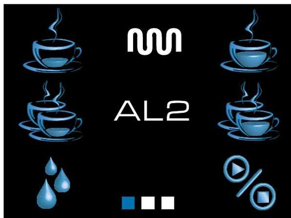
Se nella schermata indicata compare il messaggio AL2 significa che la sonda di temperatura caldaia del gruppo relativo è in corto circuito. Contattare l'assistenza tecnica per la risoluzione del problema.
