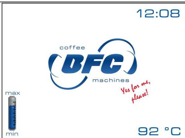
Entrando in funzione la macchina si presenta in stand-by. Lo stesso avviene se non si esegue alcuna operazione su qualsiasi display per un tempo superiore a 5 minuti. In stand-by il display visualizza ora, temperatura gruppo a cui fa riferimento il display ( solo su modelli multi boiler ) ed il livello d' acqua presente in caldaia. Premendo un punto qualsiasi del display si passa alla schermata successiva (vedi paragrafo 2)
