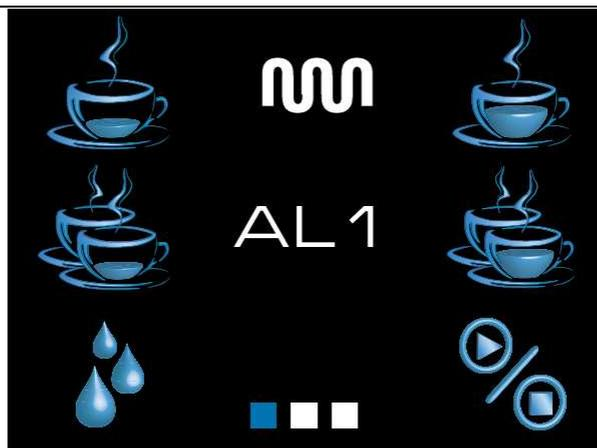
Se nella schermata indicata compare il messaggio AL1 significa che la sonda di temperatura caldaia del gruppo relativo è scollegata o interrotta. Contattare l'assistenza tecnica per la risoluzione del problema.
