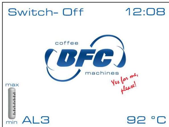
Se in fase di carico acqua in caldaia viene visualizzata la seguente schermata significa che è stato superato il tempo di riempimento livello acqua in caldaia impostato. Si rende pertanto necessario il riavvio della macchina.
