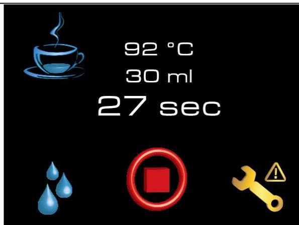
Se in fase di erogazione viene visualizzato il simbolo indicato significa che è necessario eseguire la manutenzione della macchina. Tale operazione deve essere effettuata da personale tecnico qualificato.
